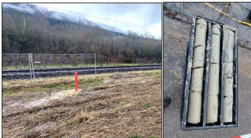
Photographies d'un piézomètre et d'une caisse à carottes 3 casiers
